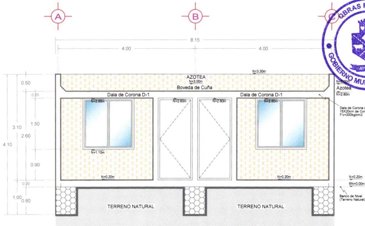
SECCION LONGITUDINAL A-A'
