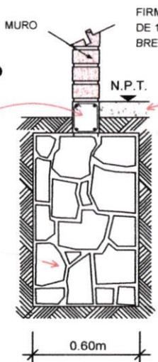
FIRME DE CONCRETO FC=150KG/CM2 DE 10CM DE ESPESOR, ASENTADO SOBRE TEPETATE COMPACTADO.
