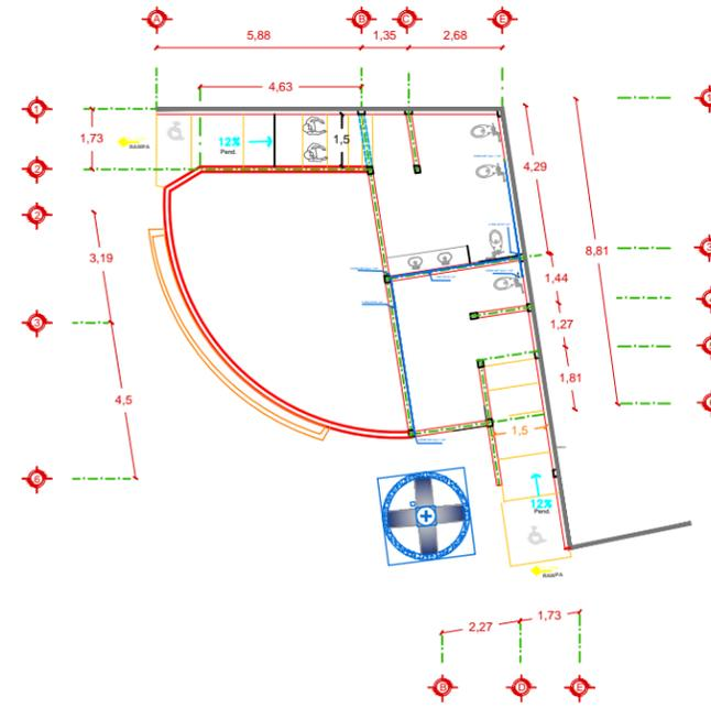
Planta Instalación Hidráulica
