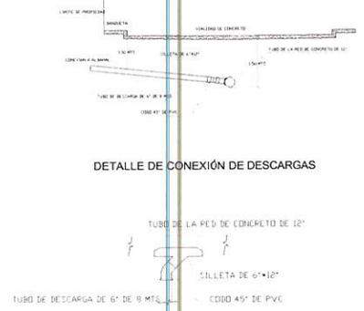
DETALLE DE CONEXIÓN DE DESCARGAS
