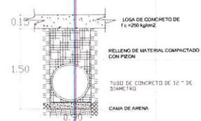
SECCION DE CEPA TIPO DRENAJE
