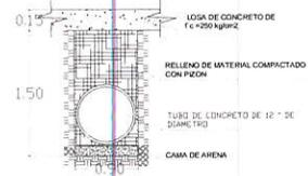
SECCION DE CEPA TIPO DRENAJE
